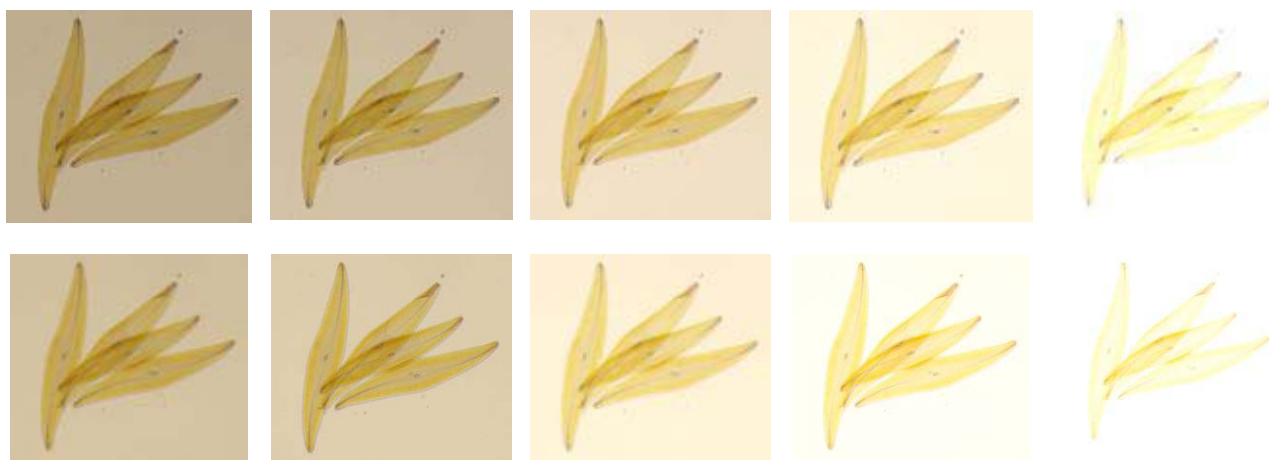
Abbildung 6: Aufnahme eines Streupräparates von Pleurosigma angulatum , Objektiv 10:1/0,25. Obere Reihe: ISO-Einstellung 200, untere Reihe 400. Belichtungskorrektur von links nach rechts –2 LW, -1 LW, +/- 0 LW, +1 LW, +2LW
