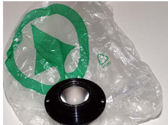
Abbildung 10: Im linken Bild die ursprüngliche, sandgestrahlte Mattscheibe (a) und eine experimentell benutzte, inzwischen aber verworfene Mattscheibe, die aus dem geätzten Mattglas eines entspiegelten Bilderhalters geschliffen wurde (b). Rechts das Rohmaterial für eine Mattscheibe aus PE-HD-Folie zusammen mit dem Ergebnis, der in den Kollektorhalter eingedrehten und -gespannten Folie.
