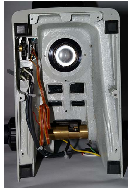
Abbildung 4: Das Stativ vor (oben) und nach (unten) Ausbau der Halogen-Beleuchtung mit den ausgebauten Teilen: Reglerplatine, Transformator, Lampenhalter mit Halogenbirne und zwei Hitzeschutzbleche. (Jeweils links Blick von hinten in den „Rücken“, rechts Blick von unten in den Fuß des Mikroskops).
