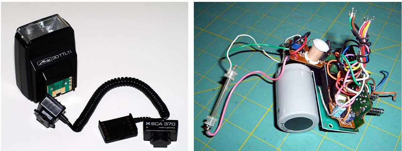
Abbildung 7: Das verwendete Blitzgerät Metz 30 TTL (mit SCA Adapter und Entfesselungskabel) vor und nach dem Zerlegen.
