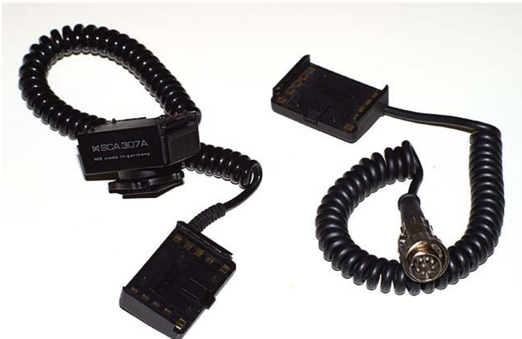
Abbildung 8: Das SCA-Kabel 307 im ursprünglichen Zustand und mit dem angelöteten 8poligen DIN-Stecker.
