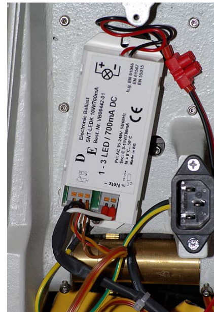
Abbildung 6: Links die Befestigung von LED und Blitzröhre auf einem Stück Alu-Profil, rechts das eingebaute Stromversorgungsmodul mit Anschlüssen.
